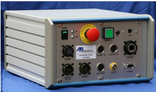
SOLO Standalone-Controller inklusive Spannungsversorgung für ABDs Gaspedalroboter
