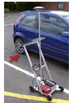
Handwagen zur Erfassung der Spurmarkierung
